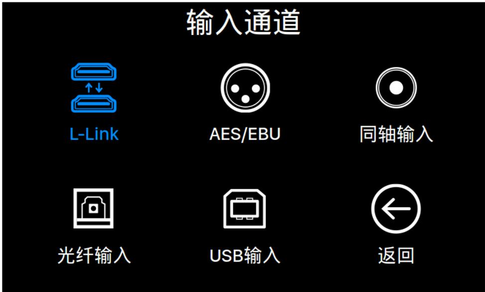
为您的 SIRIUS G2.1 选择输入通道。旋转旋钮点亮所需输入通道，按下旋钮确定切换输入通道。
