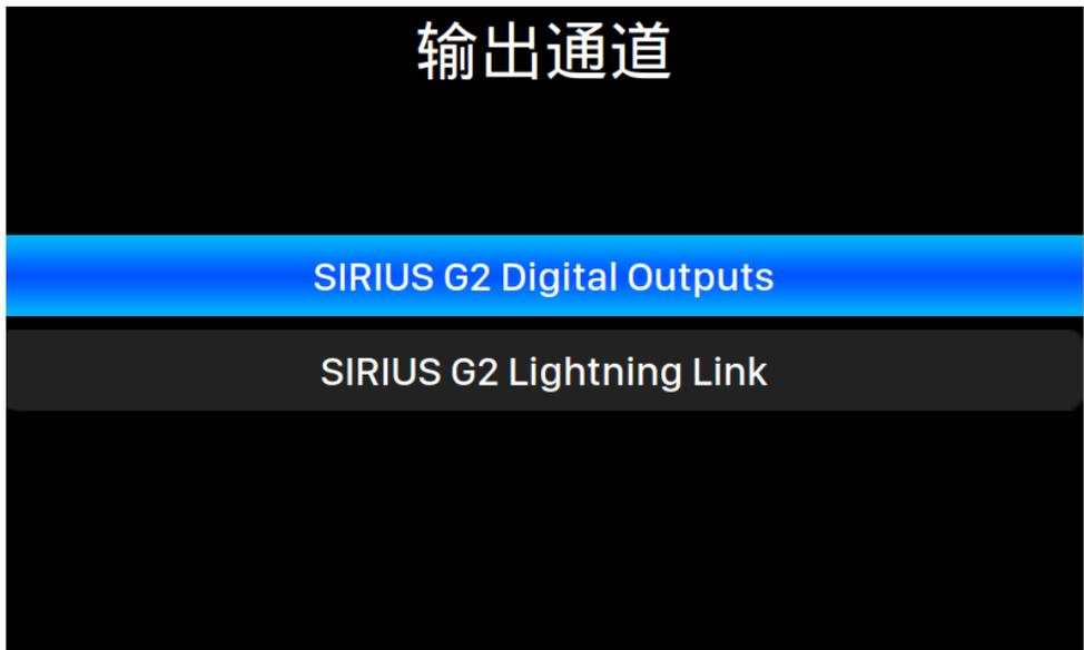
为您的 SIRIUS G2.1 选择输出通道，旋转旋钮点亮所需输出通道，按下旋钮确定。
