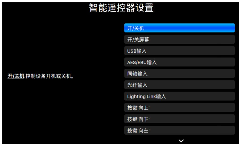
“智能遥控器设置” 菜单列举了一系列可以通过遥控器实现的操作，您可以映射您已有遥控器上的按钮上到 SIRIUS G2.1 对应的功能上。请按照菜单指导完成您的遥控器设置。以下遥控器操作对于 SIRIUS G2.1 的日常使用有很大帮助：
