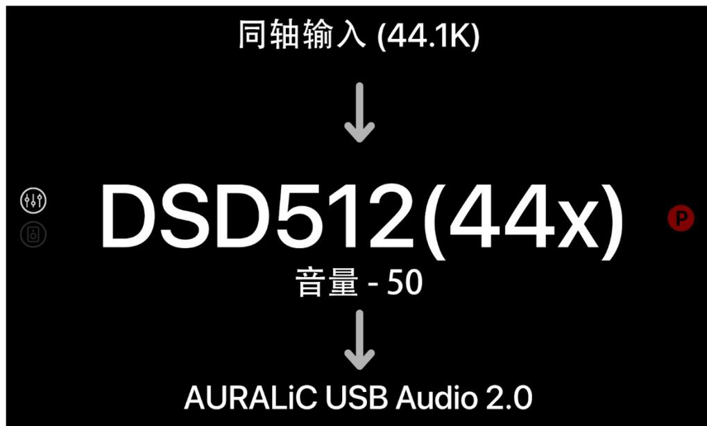
您的 SIRIUS G2.1 当前的输入通道以及输入信号的采样率显示在屏幕的顶部，输出通道显示在屏幕底部。SIRIUS G2.1 的输出采样率与音量显示在屏幕中央。
