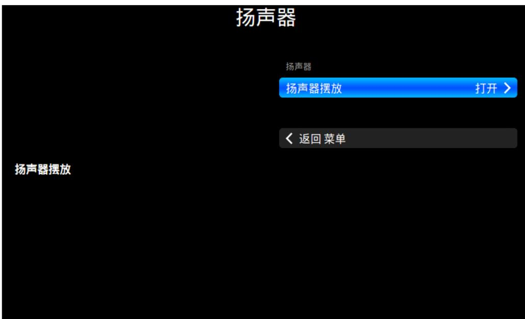
“扬声器”菜单用户添加基于距离的左右声道延迟，改变单个声道的增益补偿非理想的扬声器摆位。旋转旋钮点亮所需选项，按下旋钮确定。
