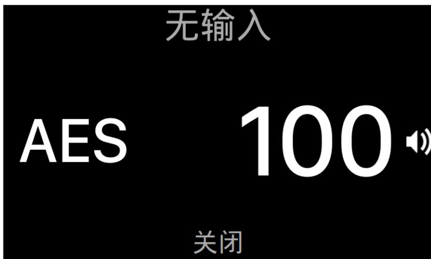
当 ALTAIR G1 启动后，使用除了流媒体输入以外的任何输入通道时，欢迎屏幕将显示当前的输入通道、采样率和音量值。如果您的 ALTAIR G1 被遥控器或者 Lightning DS 应用开启静音模式时，音量值将会闪烁，提醒您它正处于静音状态。您可以按旋钮离开欢迎屏幕，进入主菜单。
